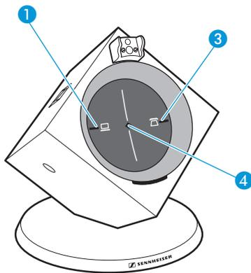
► Stecken Sie das Steckernetzteil **15** in eine Steckdose. Die LED VERBINDUNG **4** leuchtet rot. Die zuletzt verwendete Betriebsart-LED der Taste TELEFON **3** oder PC **1** leuchtet weiß.
