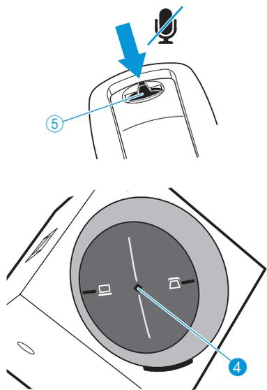
Um das Mikrofon des Headsets **während** eines Telefonats stummschalten (LED VERBINDUNG ④ der Basisstation leuchtet blau):
