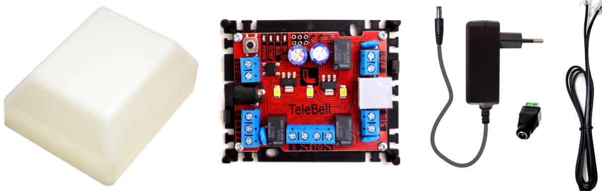
TeleBell verbindet bis 2 Klingeltaster an der Haustüre oder das Türtelefon einer Türsprechanlage und Funktürklingel mit dem DSL Router oder der Telefonanlage. Somit können auch Telefone den Türruf signalisieren und die Tür öffnen. Bei der Fritzbox lässt sich zusätzlich eine Kamera einbinden.
