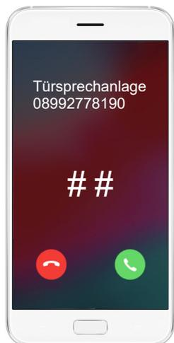
Rufen Sie mit dem Smartphone die Rufnummer an, die Sie vorher der Türsprechanlage zugeteilt haben. Ist die Verbindung hergestellt hören Sie das Außengeräusch der Türsprechanlage. Sie können jetzt sprechen und hören sowie Programmierungen vornehmen z.B. das Aktivieren der Rufumleitung oder das Öffnen der Tür.
