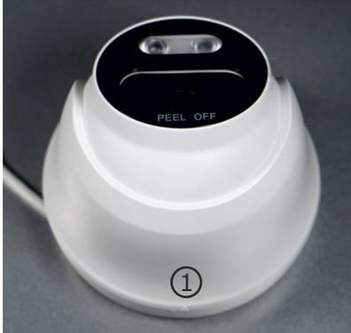
Schliessen Sie die Kamera mit den Steckern an das LAN Kabel an. Halten Sie die Kamera an das Gehäuseunterteil und führen Sie das Gehäuseoberteil darüber.
