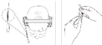
Le casque Space mono peut être porté avec le micro des deux côtés. Pour ce faire, maintenez l'écouteur fermement et faites pivoter la perche de 180°. L'angle maximal de rotation est de 270°.
