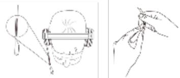
Das Space Mono Headset kann an beiden Ohren getragen werden. Um die Kopfhörerposition von rechts auf links umzustellen, halten Sie den Ohrbügel mit Ihrer linken Hand fest und drehen Sie den Mikrofonarm um 180° vom Kabel weg. Den Mikrofonarm kann man maximal um 270° drehen.
